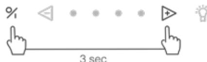
Zum Ausschalten der InTouch-Funktion halten Sie die Tasten ① und ② 3 Sekunden lang gleichzeitig gedrückt. Die zweite und vierte LED blitzen 3 Mal zur Bestätigung. (Das Gerät muss ausgeschaltet sein.)
