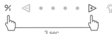
Pour désactiver la fonction InTouch, appuyer simultanément sur les touches ① et ② pendant 3 secondes. Les 2ème et 4ème LEDs clignotent 3 fois pour confirmation. (L'appareil doit être éteint).
