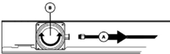
A. Débranchez d'abord le câble qui alimente la LED à remplacer. Pour ce faire, détachez le verrouillage en y exerçant une légère pression tout en tirant.
