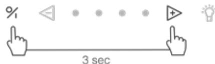
Om de InTouch functie uit te schakelen toets ① en toets ② tegelijk indrukken voor 3 seconden de 2e en 4e LED knipperen 3 keer ter bevestiging. (Het toestel moet uitgeschakeld zijn).
